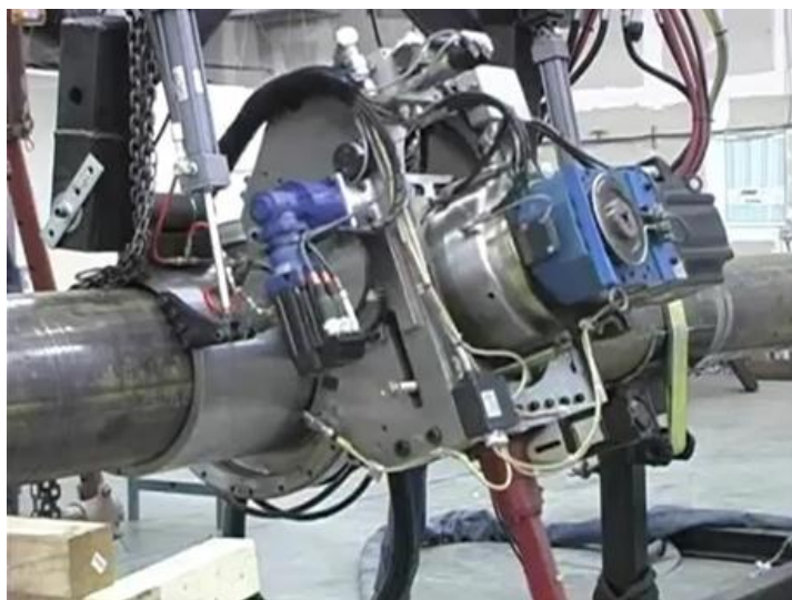
Рис. 4. Установка для орбитальной сварки
