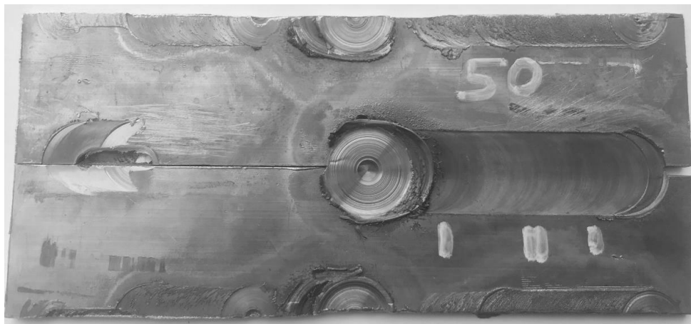
Рис. 4. Образец полученный СТП
