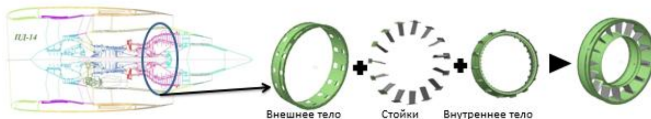
Рис. 1. Схематическое расположение опоры ГТД, ее основные части
