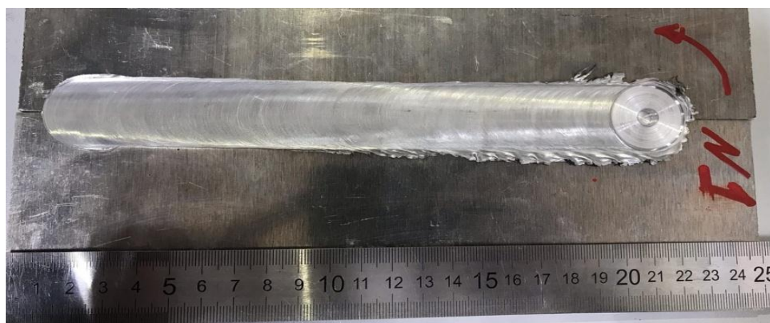
Рис. 3. Сварка алюминиевого листа толщиной 6,0 мм способом СТП
