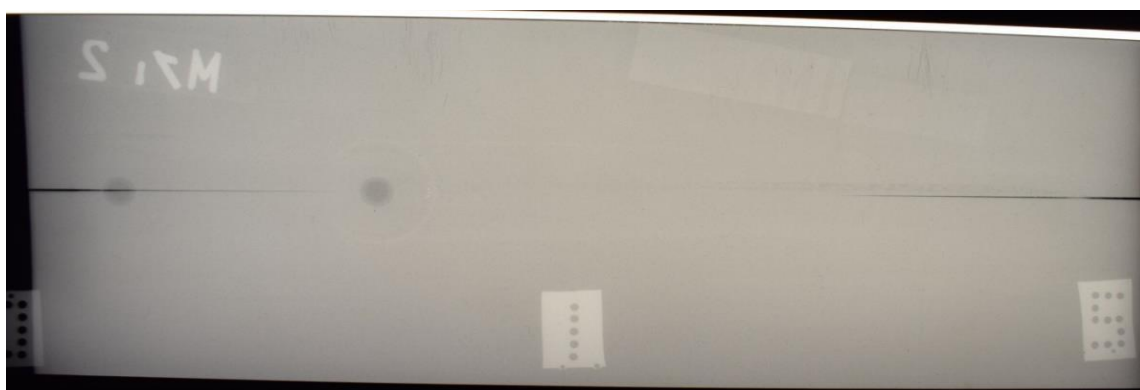
Рис. 4. Рентген снимок образца, полученного способом СТП меди 5 мм
