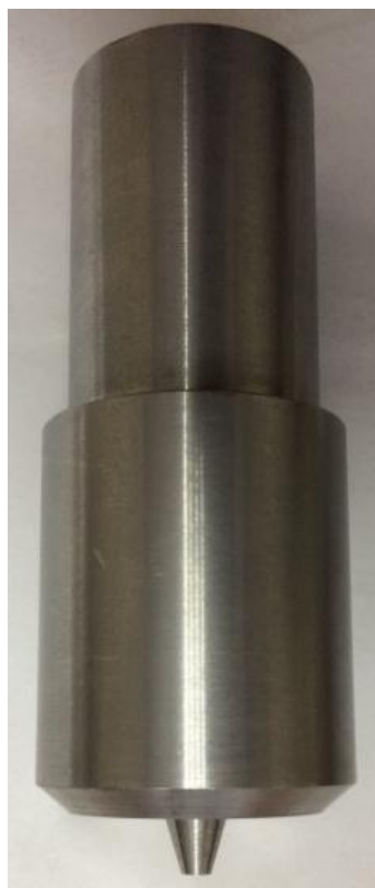
Рис. 2. Рабочий инструмент для СТП алюминия 6,0 мм
