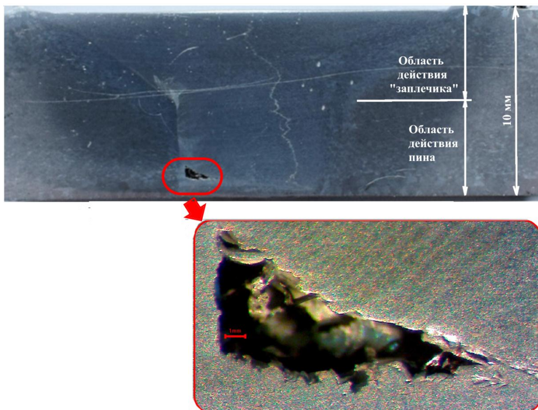
Рис. 8. Макрошлиф темплетата №4 с дефектом типа “заглаженный непровар”
