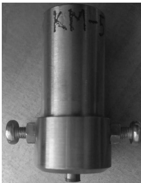
Рис. 3. Инструмент для СТП меди 5 мм
