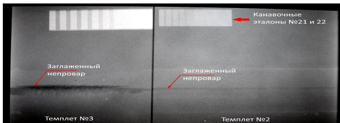
Рис. 3. Радиографический контроль темплета 2 и 3
