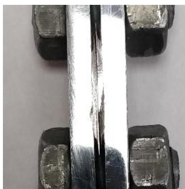
Рис. 1. Вид образцов в струбцине под индентирование встык
